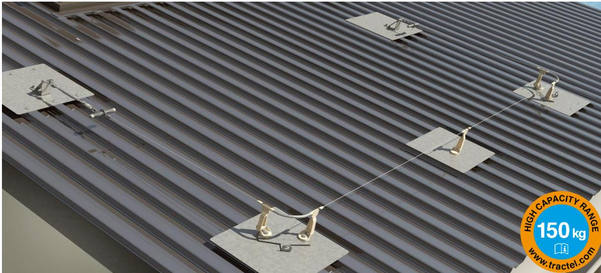
La ligne de vie monocâble Travflex™ 2 offre un mouvement en douceur. Elle permet au coulisseau de se déplacer librement sur les ancrages intermédiaires, ce qui minimise l'usure et ne requiert pas de manipulation de l'utilisateur. Les mains de l'utilisateur restent libres pour toute autre tâche. Elle est conçue pour limiter les forces transmises à la structure en cas de chute pour une installation sur des structures légères telles que les toitures à bacs acier.
